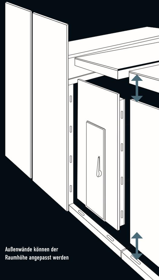
Außenwände können der Raumhöhe angepasst werden
