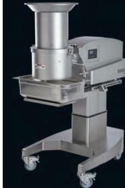
M 50 höhenverstellbares Fahrgestell mit 2-Kammer-Aufsatz
